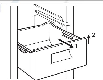
Корзины морозильного отделения оснащены стопором, препятствующим их случайному выниманию или падению. Чтобы вынуть корзину из морозильной камеры, потяните ее на себя. Когда она достигнет конечного положения, приподнимите передний край корзины и снимите ее.
